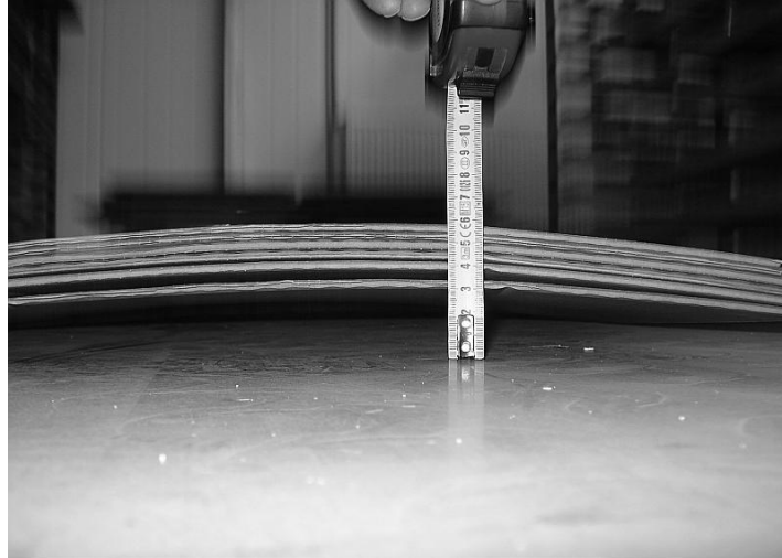
Rys. 1. Arkusz podczas pomiaru płaskości leżenia arkusza tektury Źródło: opracowanie własne
