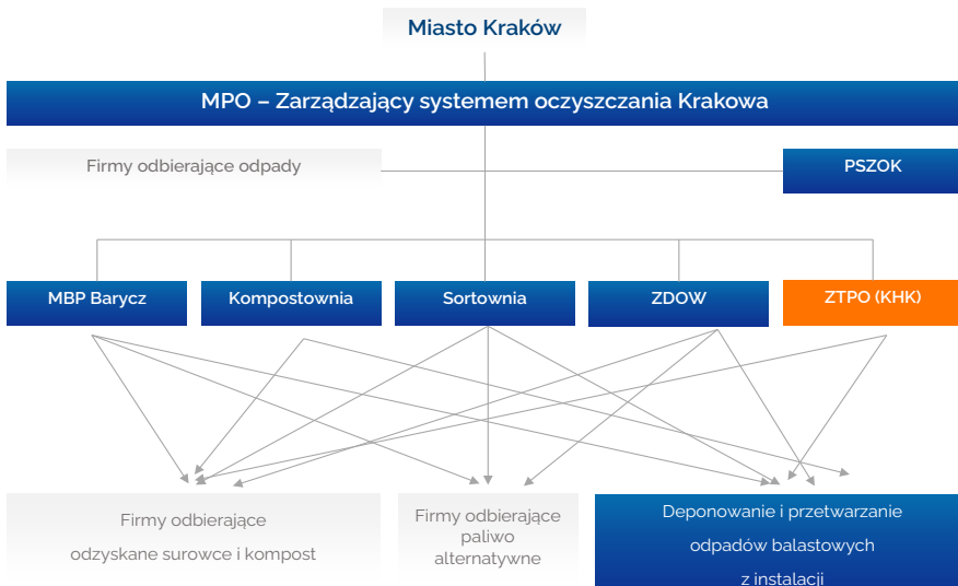
Ilustracja I.3. Kluczowe instalacje do przetwarzania odpadów komunalnych w ZSGOK Źródło: opracowanie własne na podstawie danych MPO w Krakowie
