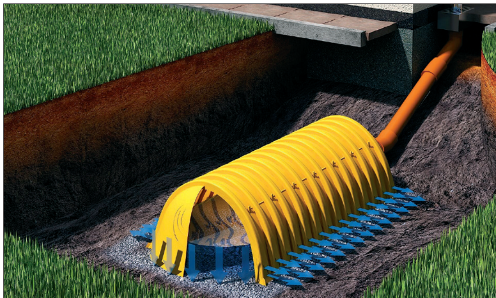
Rys. 5. Podłączenie komory drenażowej do budynku jednorodzinnego
